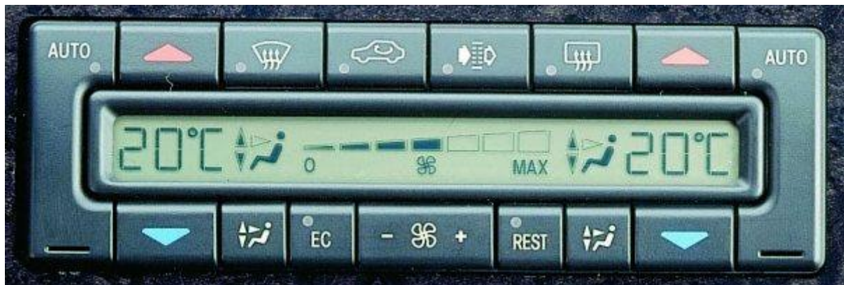
Abbildung 8: Typisches Bedienteil einer automatischen Klimatisierungsanlage
